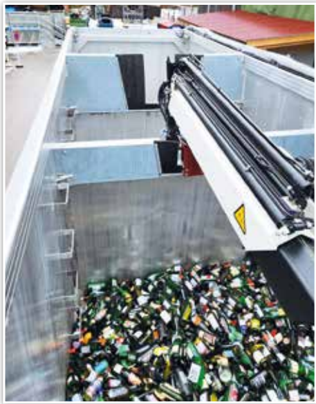
Die gesammelten Gläser und Flaschen aus den Grün-, Weiß- und Braunglas-Iglus werden in den gleichen Container geleert. Zur Trennung der Glasfarben hat dieser 3 Kammern.
